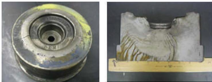
Слика 7.6: Капап разорен поради оптоварување
